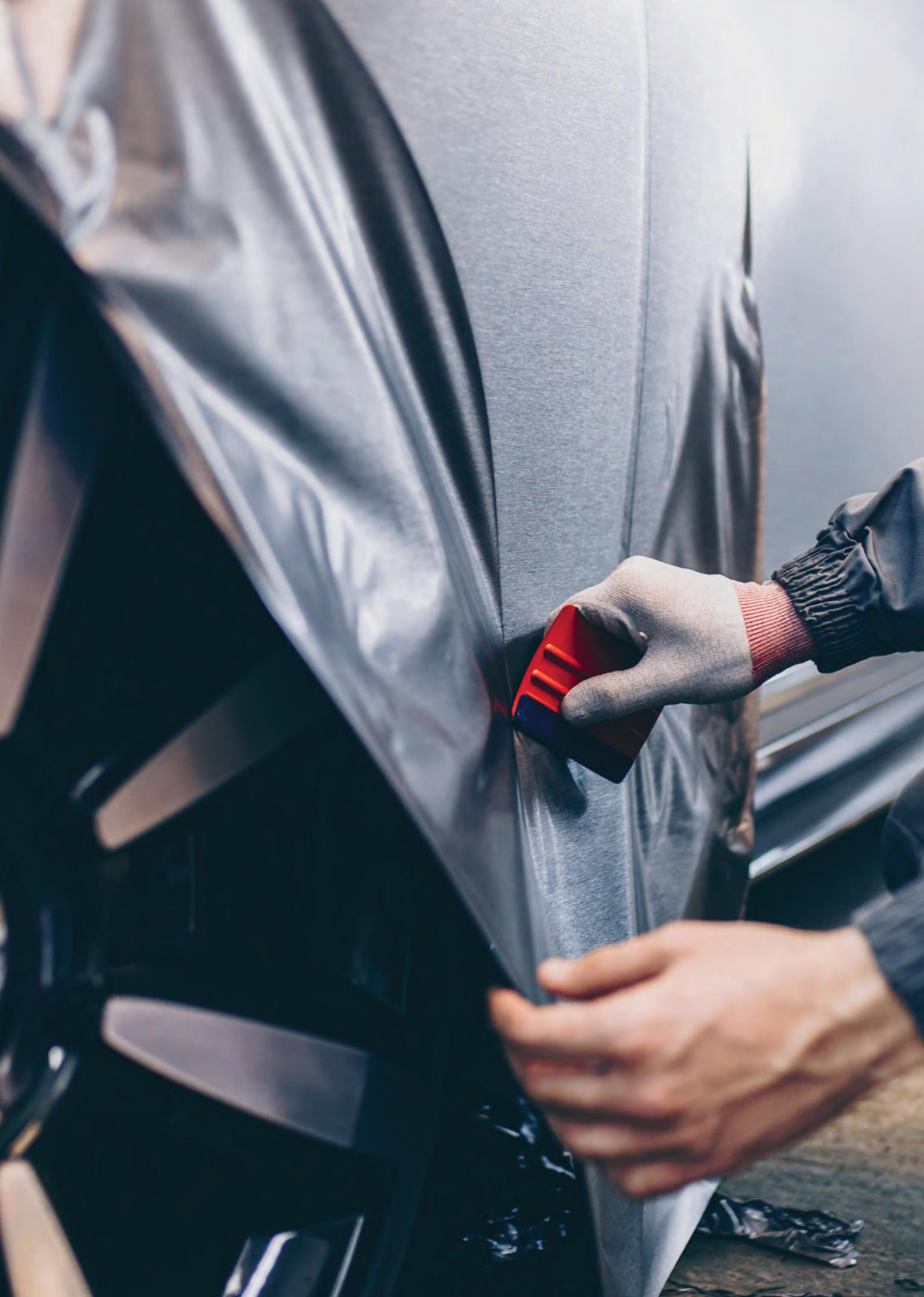
**MONOMERFOLIE MIT VERSTÄRKTER KLEBKRAFT - Solvent-Kleber, permanent**
